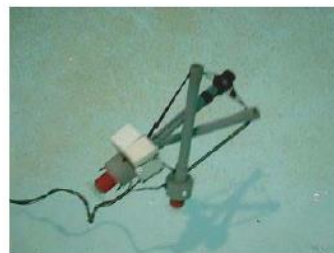
変形により運動性能を可変とする水中ロボット
