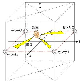
機械学習で予め決定  $oldsymbol{x}=f(s_1,s_2,s_3,s_4)$  推定された端末位置 センサが検出した磁界
