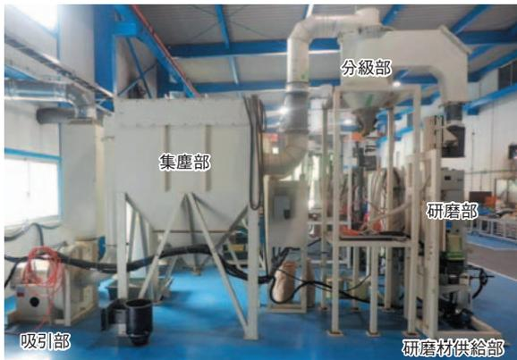
写真3 研磨再生装置
