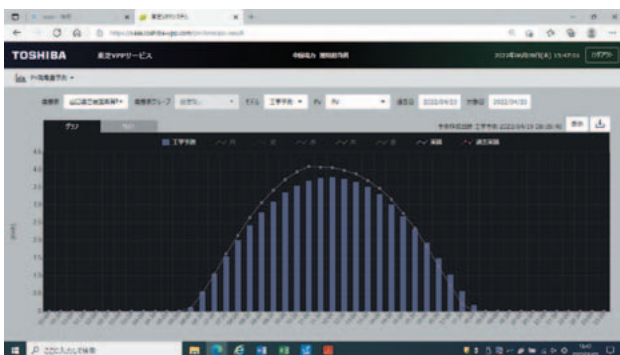
図3 VPPクラウドシステムによる太陽光発電量予測の例(注)
