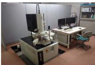
**FE式走査型電子顕微鏡**
