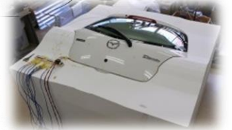
断熱性能測定装置の外観
