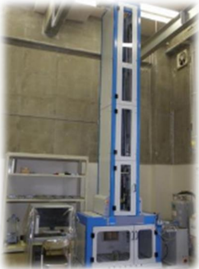
衝撃圧縮試験機 (曲げ強度, 軸圧縮強度)
