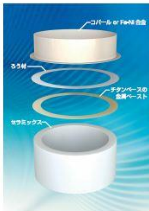
セラミックスと金属の 接合図
