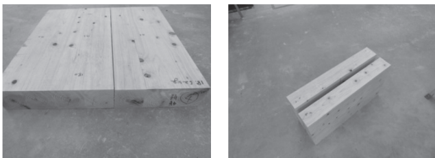
写真 22. 試験体 4 の終局状況
