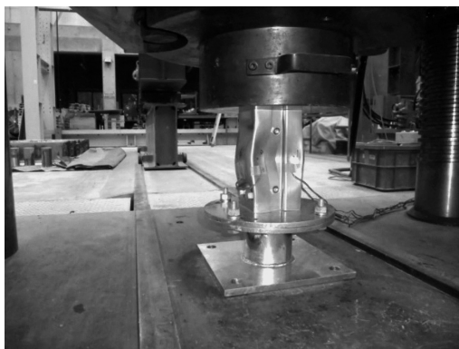
写真 10. 圧縮試験体の終局状態
