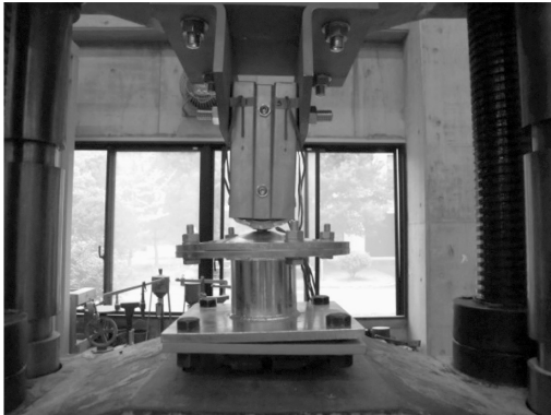
写真 7. 最終加力時の引張試験体の状態
