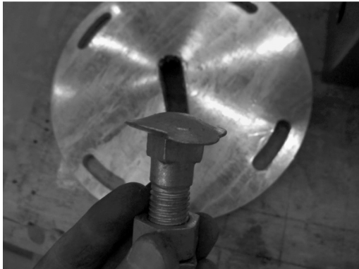
写真 8. 加力試験後の M16 ボルトの状態
