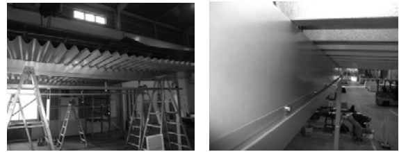
写真 11 最終載荷状況と除荷後残留変形
