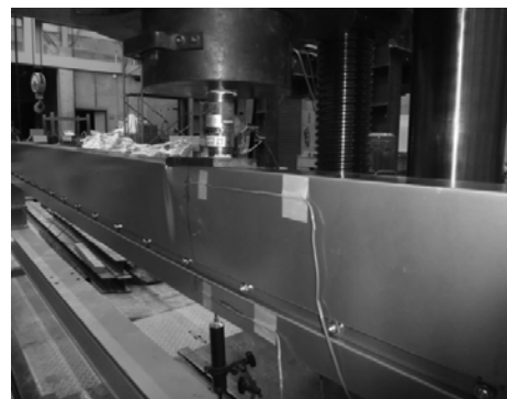
写真4 試験体 No.5 の終局状況 (加力部の局部座屈)
