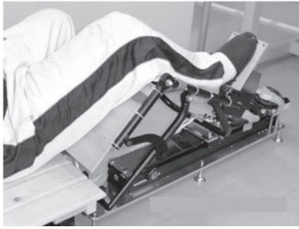
図 2. 試作した筋力トレーニング機能付き CPM 装置
