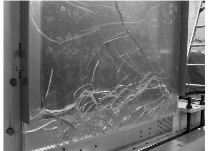
写真 3. ガラス割れ（16PA）
