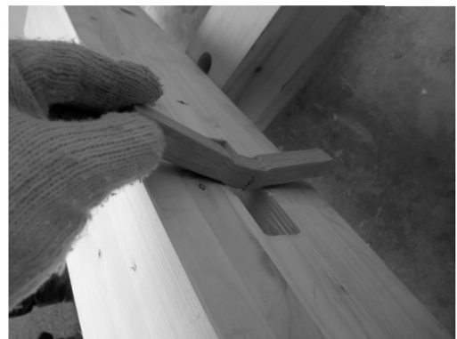
写真 5. 鼻栓の折れ曲がり (試験体 1)
