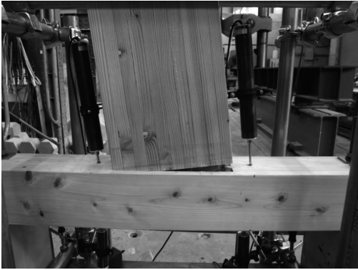
写真 13. 試験体 4 の終局状況
