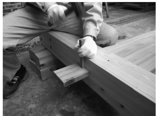
写真1. 試験体1 (小根ほぞ鼻栓締・大入仕様)
