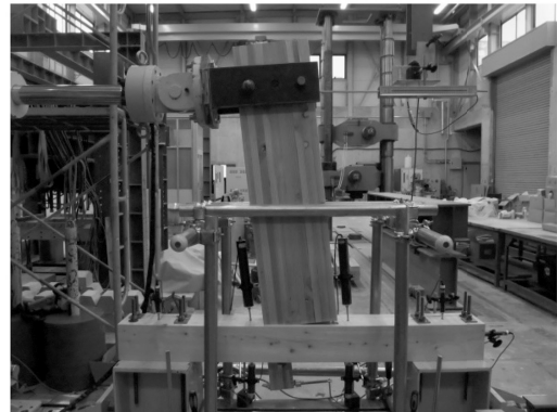
写真 4. 試験体 1 の終局状況
