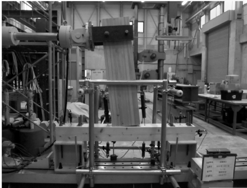
写真6. 試験体2の終局状況
