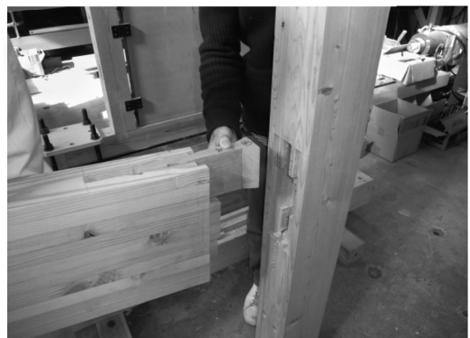
写真2. 試験体2 (雇蟻車知栓締・大入仕様)
