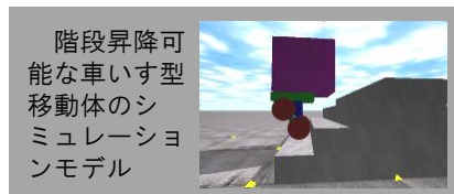
倒立二輪制御により階段昇降可能とした車いす型移動体
