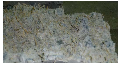
竹繊維を混入したコンクリートの断面
