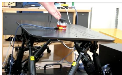
図2 パラレルリンクによる多軸負荷実験の様子
