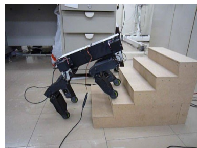
図2 樹脂3Dプリンタによる1/3小型試作機の階段上り実験
