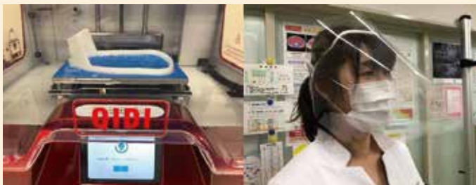
3Dプリンタでの製作の様子(左)、医療用フェイスシールド(右)
