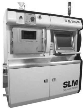
図 2 導入した金属 3D プリンタの外観
