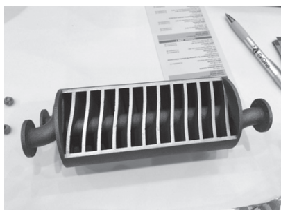
図 2. バインダージェット方式による製品例 (PowderMet2016, Boston, ExOne 社ブース展示)
