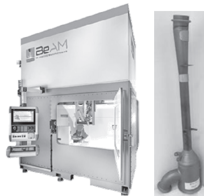
図 1. デポジション方式の装置と製品例 (提供 : BeAM 社)
