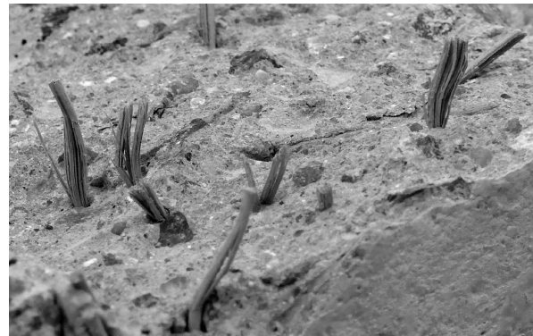
写真 3. 破断面における竹棒の様子
