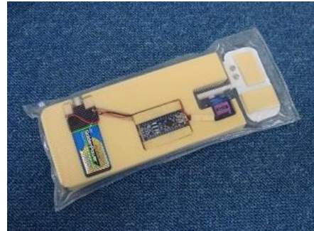
外殻を樹脂フィルムとする魚型水中ロボット
