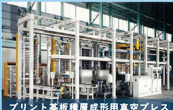
銅張積層板成形用36段真空プレス
