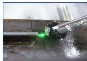
ノズル型レーザーピーニングによる疲労強度の強化
