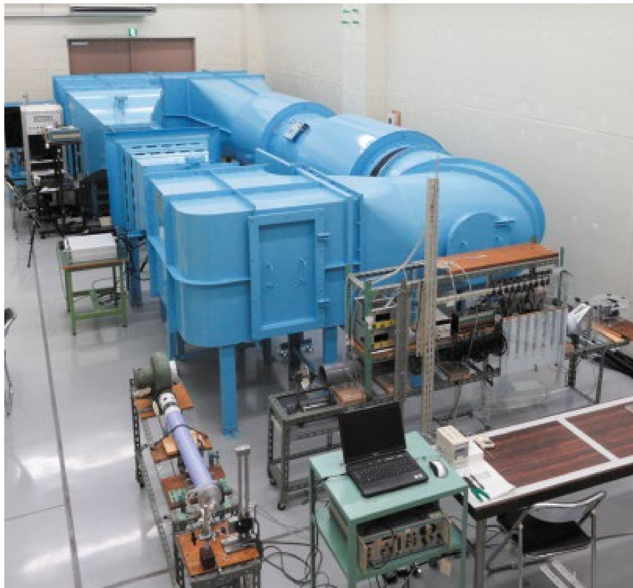
大型可変風速風洞装置 (測定部断面600×600mm 2 )
