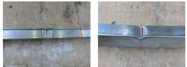
かしめ上側試験体
