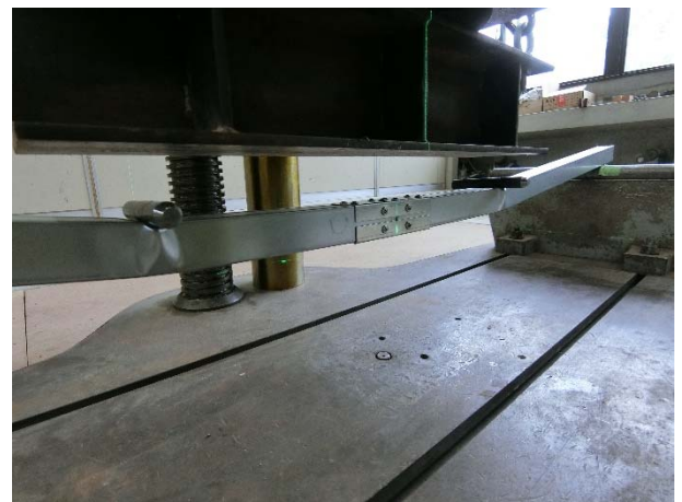
写真 9 試験体の終局状況 (□45×45×0.8・外金物板厚 1.2mm)
