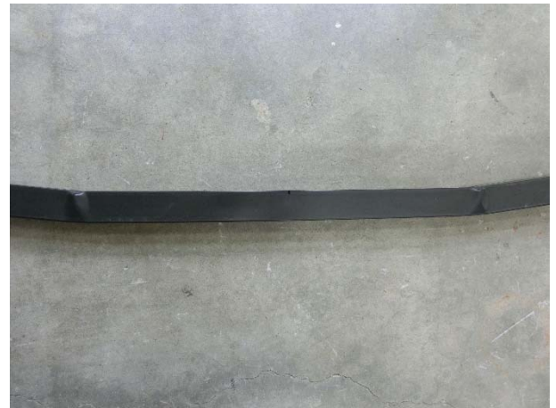
写真 8 試験体の終局状況 (□45×45×0.8・連続体)
