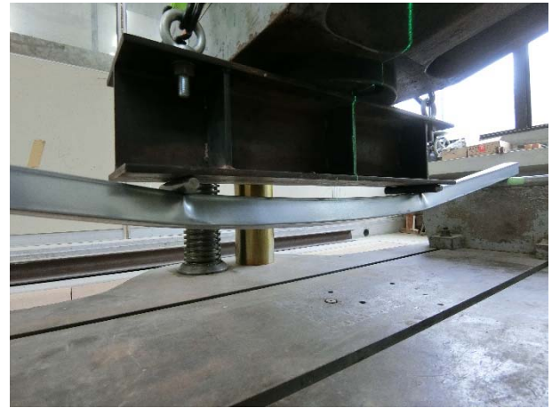
写真 5 試験体の終局状況 (□45×45×1.2・連続体)
