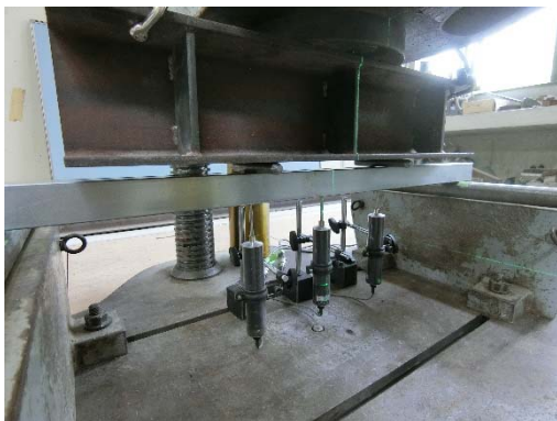
写真 1 部材の曲げ試験(かしめ上側)
