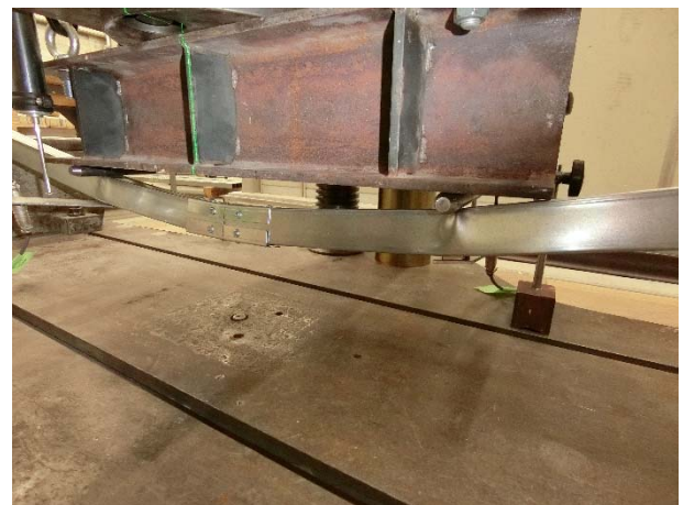
写真 7 試験体の終局状況 (□45×45×1.2・外金物板厚 1.2mm)
