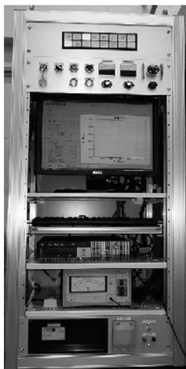
図5. 風洞運転の操作盤
