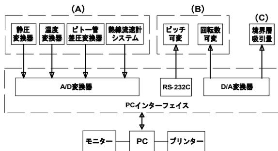
図4. 風速制御システムの機器構成
