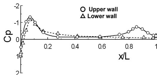
図 12. 定常風下の圧力分布 ( $V = 20$  m/s)
