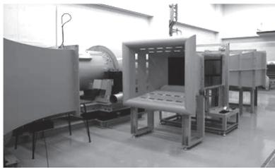
図 2. 風洞吹き出し口とコレクター
