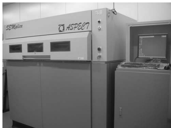
図 5 開発したレーザ積層造形装置
