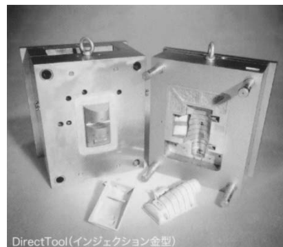
図3 射出成型金型（EOS ホームページ）
