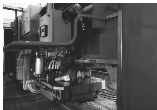
図2 搾乳ロボット (株式会社コーンズ・エージー提供)
